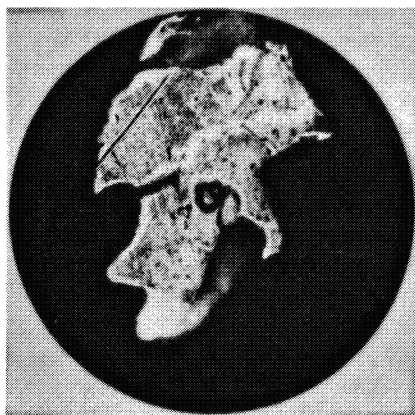
Рис. 18. Зернистое внутреннее строение золотинок. По периферии зерен и их границам развита кайма, обедненная серебром (белое). Полированный срез, протравленный раствором хромового ангидрида в соляной кислоте. Увел. 200
