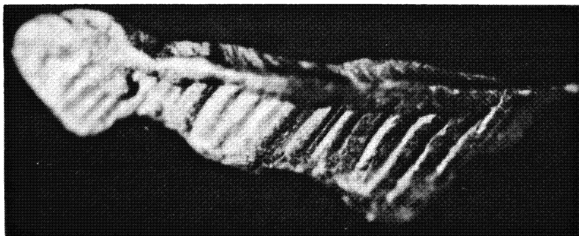
Рис. 6. Дендрит золота; от центральной оси под одинаковым углом отходят удлиненные кристаллические выступы. Увел. 20
