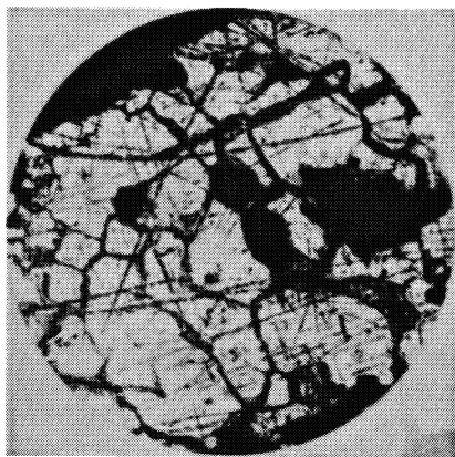
Рис. 24. Реликты золота (белое) в более позднем высокосеребристом золоте (серое). Полированный срез, протравленный раствором хромового ангидрида в соляной кислоте. Увел. 90
