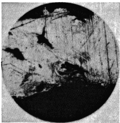
Рис. 32. Зоны трансляций в первичных зернах золотинок из россыпи. Полированный срез, протравленный царской водкой. Увел. 250
